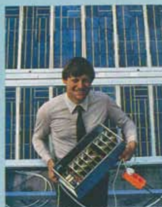
Dieser im Freiburger Fraunhofer-Institut für Solare Energiesysteme entwickelte Inverter wandelt Gleichstrom aus Solarzellen beinahe verlustlos in 220-Volt-Wechselstrom um
